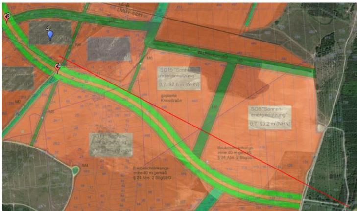
Abbildung 22: Potenzielle Blendung durch PV-Feld 4 nur durch Streckenabschnitt östlich des Solarparks (rote Linie 295°)
