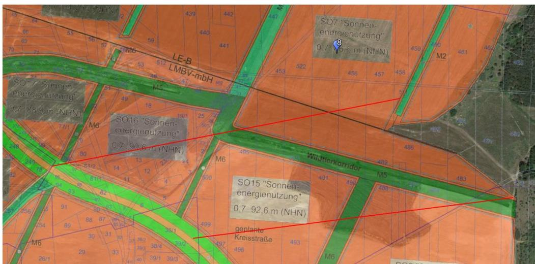
Abbildung 24: Sichtunterbrechung zu PV-Feld 8 durch Wildtierkorridor/Gehölzstreifen M5, Richtung der Blendung als rote Linien 74°-78°
