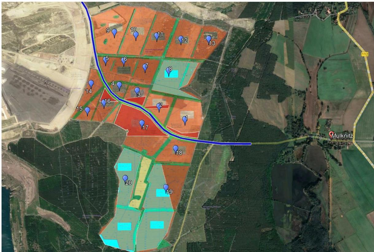
Abbildung 14: Ergebnisse für PV-Flächen 1-20: für Ost/West-Ausrichtung geeignete PV-Flächen (hinsichtlich potenzieller Blendung) in türkis, PV-Flächen durch welche in Südausrichtung potenzielle Blendung ausgeht in rot
