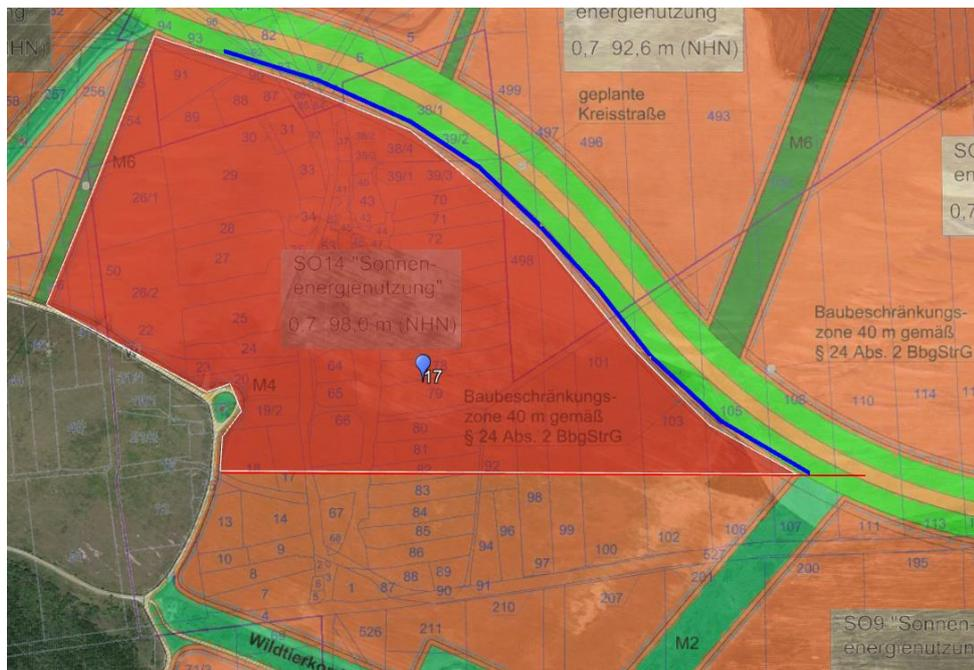
Abbildung 36: Bereich von PV-Feld 17, durch welchen potenzielle Blendung ausgeht (rote Fläche), mögliche Blendschutzmaßnahme ist eine Sichtunterbrechung (blaue Linie)
