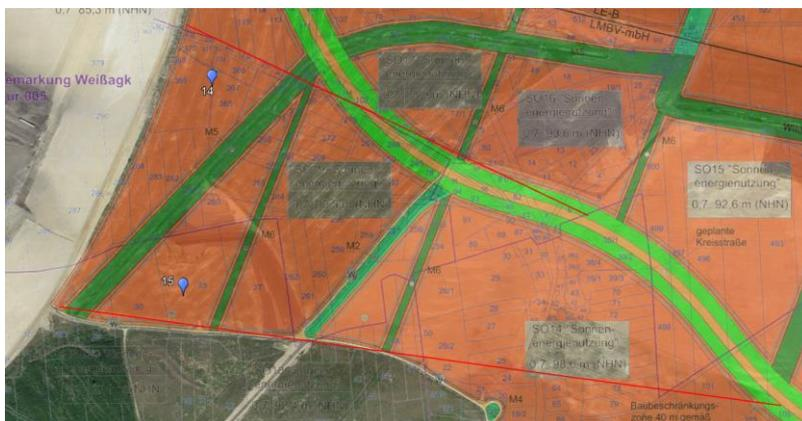
Abbildung 26: Sichtunterbrechung zu PV-Feld 14/15 durch Wildtierkorridor/Gehölzstreifen M2/M5/M6, Richtung der Blendung als rote Linien 277°-295°
